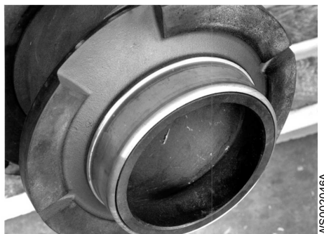
Rysunek 13: Pierścień ścierny wirnika
