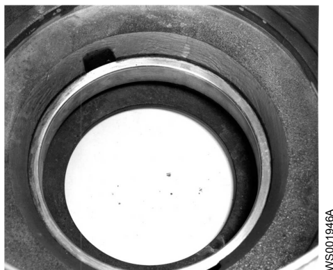
Rysunek 12: Pierścień ścierny w obudowie pompy
